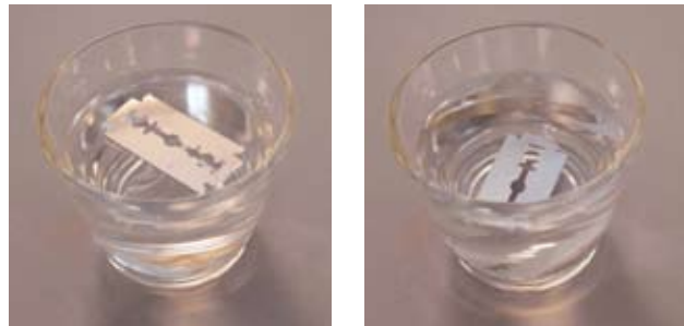
Abbildung 1: Im linken Bild schwimmt eine Rasierklinge auf Wasser. Im rechten Bild wurde die Oberflächenspannung des Wassers durch Zugabe von Tensiden so weit herabgesetzt, dass das Gewicht der Rasierklinge nicht mehr getragen werden kann.
